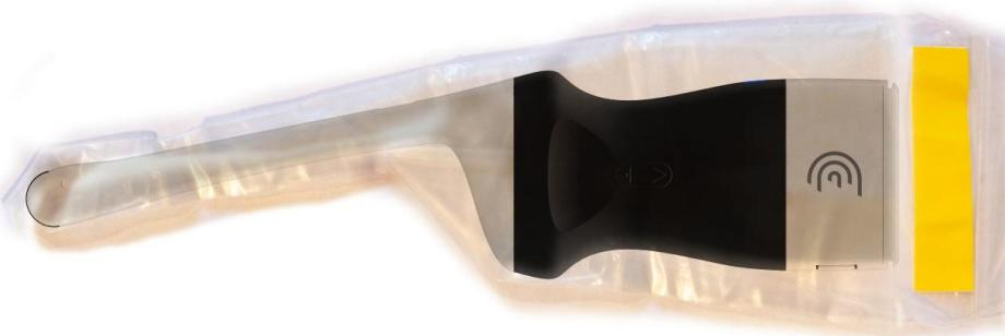
Når du er færdig med at bruge Clarius Scanner EC7 HD, skal du rengøre den med det samme (for instruktioner, se Rengøring af Clarius Scanner HD på side 38), efterfulgt af endnu en high-level desinfektion. Hvis du har brugt en Clarius Fan HD (CIDN 50-02-00061), skal du fjerne blæseren inden desinfektionen og følge instruktionerne for en mellem desinfektion (for instruktioner, se *Desinficering af Clarius Fan HD* på side 41).
