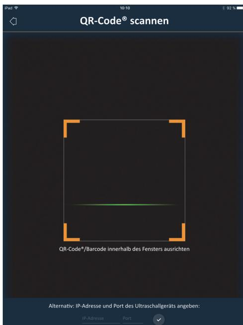
Wenn der QR-Code®- / Barcodescanner verwendet wird und mehrere Barcodes eng nebeneinander dargestellt sind, kann der Rahmen angepasst werden, um nur einen Barcode im Fenster anzuzeigen.
