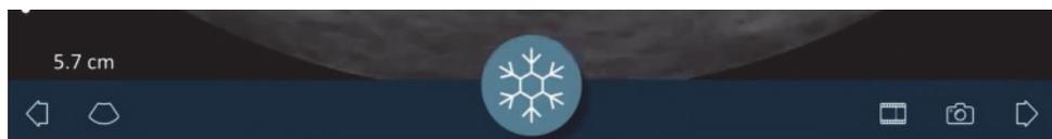
Hierdurch wird die Kinodarstellung unterbrochen. Das Symbol wird kleiner angezeigt, das Clarius Ultraschallgerät wechselt in den Standby-Modus, und die Leuchte ändert sich zu Blau.
