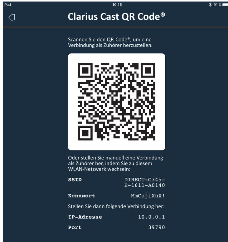
Das Wi-Fi-Direct-Netzwerk des Clarius Ultraschallgeräts verwendet stets die IP-Adresse 10.0.0.1. Wird eine andere IP-Adresse angezeigt, verwenden Sie nicht Wi-Fi Direct.
