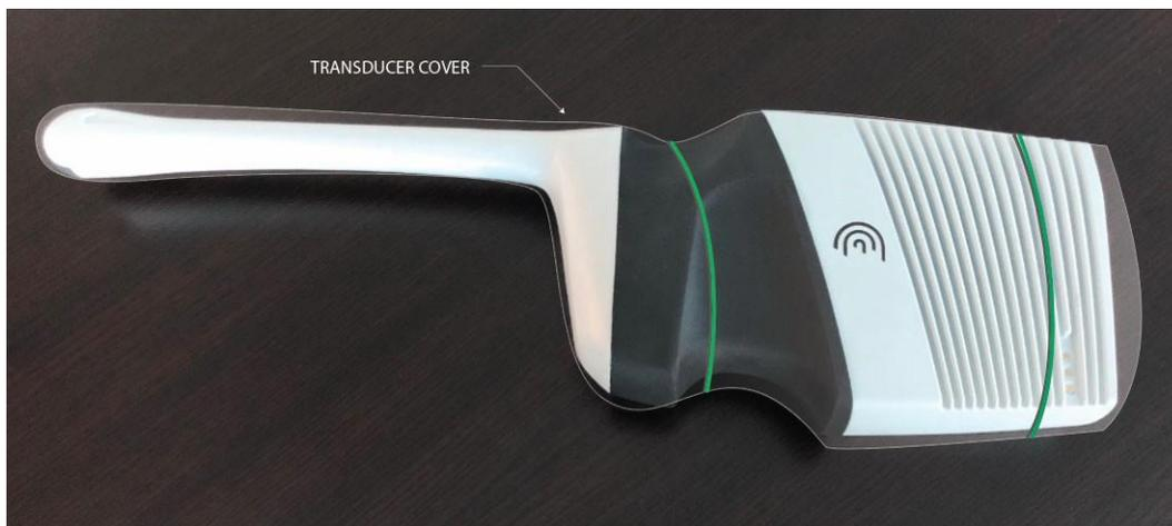
Quando terminar de usar o Scanner Clarius EC7, limpe-o imediatamente (para instruções consulte Limpeza do scanner Clarius na página 33), seguido por outra desinfecção de alto nível. Se um ventilador Clarius (CIDN 99-02-00028) foi usado, remova o ventilador antes da desinfecção de alto nível e siga as instruções para uma desinfecção de nível intermediário (para instruções Desinfecção do ventilador Clarius na página 34).
